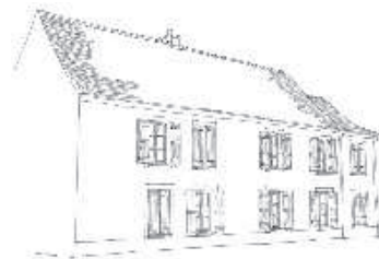
Les ouvertures des maisons de bourg sont ordonnancées horizontalement et verticalement
