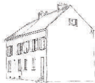
Façages, égouts de toiture et linteaux alignés sur deux maisons mitoyennes. L'ouverture dans le pignon n'est pas dans l'axe du faîtage
