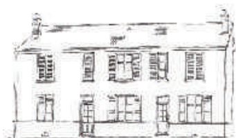
Les ouvertures des maisons rurales sont ordonnées horizontalement et verticalement
